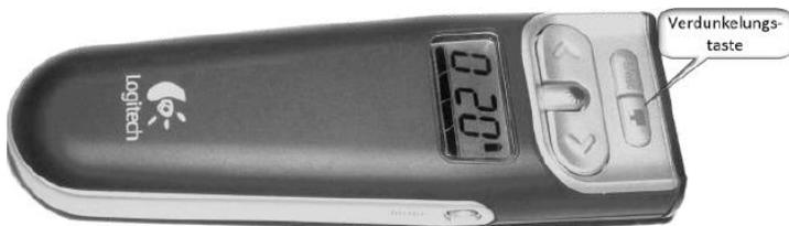
Abbildung 8-3: Projektion per Fernbedienung abschalten
